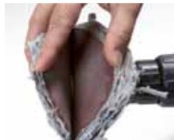
Kante anschließend mit Schleifschwamm (Körnung ca. 100) nacharbeiten. Dabei in Strukturlaufrichtung über die Kante schleifen.
