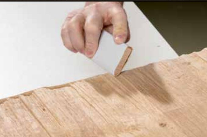
Enge Strukturverläufe müssen mit geeigneten Schleifpapierträgern nachgearbeitet werden.
