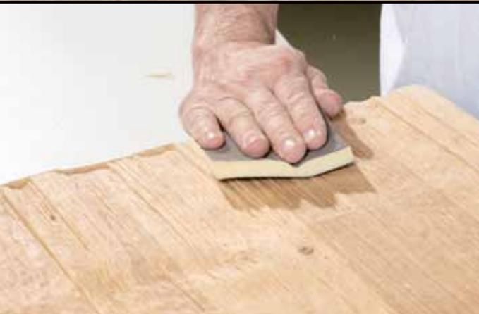
Kante anschließend mit Schleifschwamm (Körnung ca.100) nacharbeiten. Dabei in Strukturaufrichtung über die Kante schleifen.
