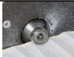
Um ein Ausreißen der Kante zu vermeiden, ist es wichtig das Werkzeug entgegen der Laufrichtung zu führen.
