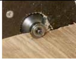
Überstände mit Profilfräser nacharbeiten. Dabei sollten möglichst kleine Werkzeugquerschnitte benutzt werden. Es ist notwendig einen Anlaufring (Anlaufkugellager) zur sauberen Führung zu montieren. Auch hier ist die Kante geprägt durch die Wahl des Werkzeugs.
