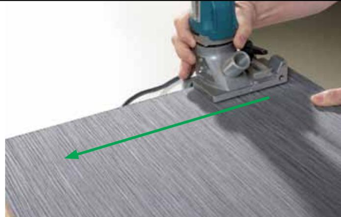
Ob Radius oder Fase, wichtig ist der Einsatz möglichst kleiner Werkzeugquerschnitte.
