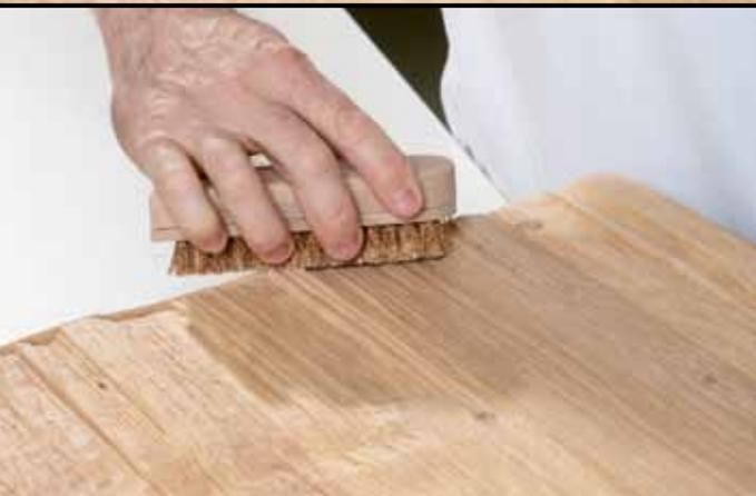
Struktur anschließend mit einer feinen Kupferdrahtbürste in Strukturrichtung säubern.
